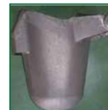
アルミ溶湯表面の酸化物を巻き込まないよう、溶湯内部から溶湯をラドル内に注ぎ込みます
