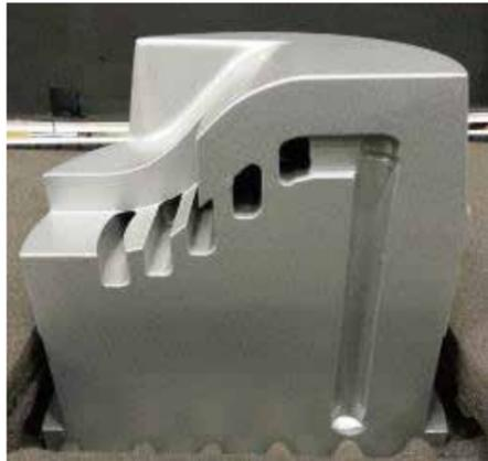
特殊な製造方法により任意の形状を作成できます。工具鋼の種類の制限はありません。分流子・ブッシュ・ボアピンなどの金型部品に、従来の方法では加工できなかった冷却回路を設計できるので、冷却性能が向上しサイクルタイムを短縮させることができます。
